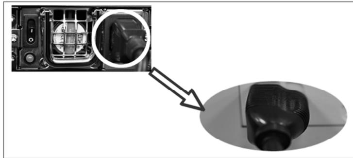
2. 将 RJ-45 网络线插入网络端口，另一端则接上您的 switch/hub/router，或是桌上型/笔记型计算机。
