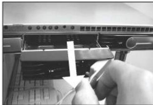
3. 將準備好的SATA 硬碟裝進硬碟盤，並依照下圖指示的螺絲位置將四顆螺絲鎖上。
