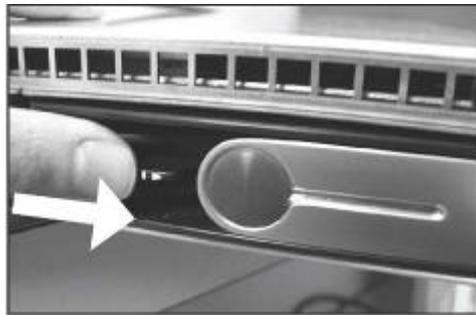
2. 依照圖片指示方向將硬碟盤拉出。
