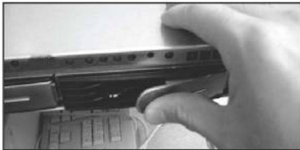
6. 重複以上動作安裝您所準備的所有硬碟。使用附上的機殼托架螺絲將側邊兩個機殼托架鎖上。
