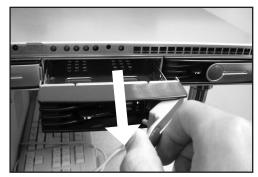
3 将准备好的SATA 硬盘装进硬盘盘,并依照下图指示的螺丝位置将四颗螺丝锁上。
