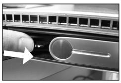
2 依照图片指示方向将硬盘盘拉出。
