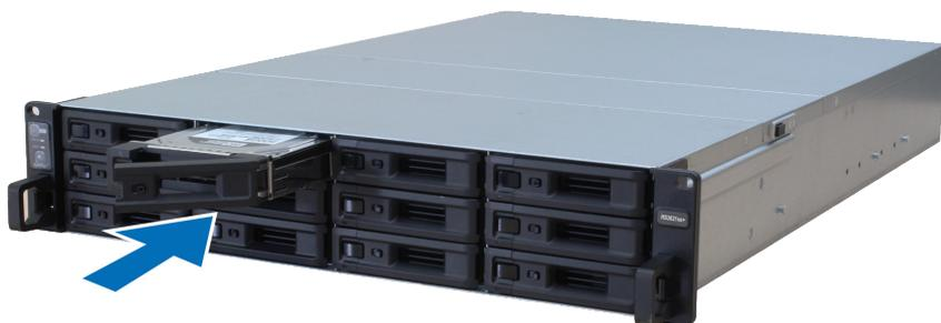
**Observación:** Asegúrese de que la bandeja de discos está totalmente insertada. De lo contrario, puede que el disco no funcione correctamente.
