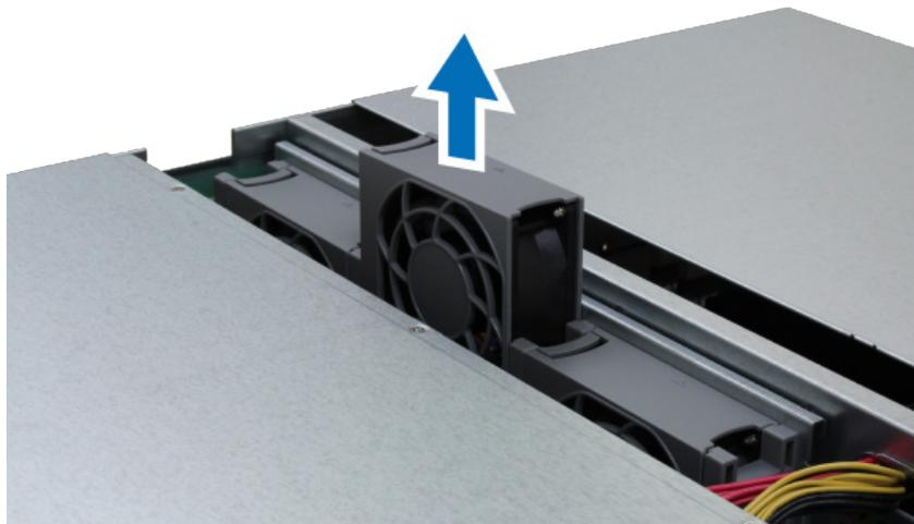
5 准备新风扇，并将其滑入 RackStation。确认风扇按如图所示正确对齐。
