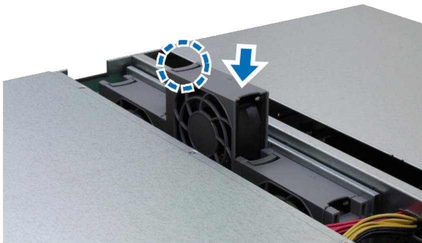
6 按步骤 2 的卸下方向的相反反向来放回风扇护盖。
