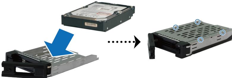
• 对于 2.5 吋硬盘：将硬盘置于硬盘托盘，请将托盘翻面，将下图所示 4 颗螺丝拧紧以固定硬盘。
