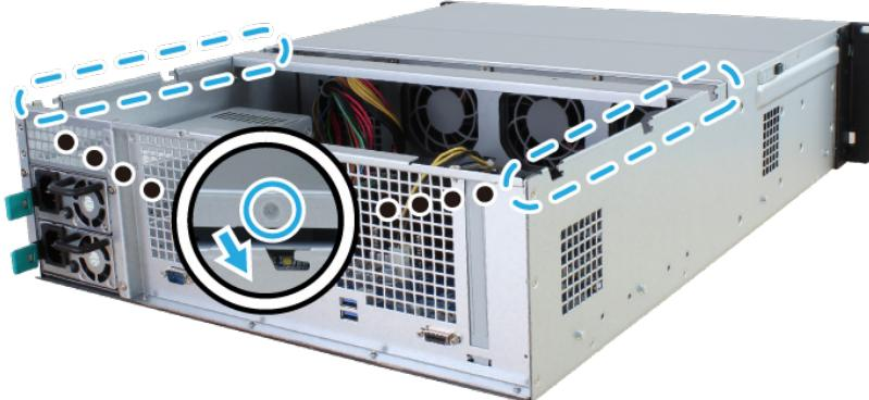
**b** 放置后顶盖，并锁紧您在步骤 2-a 中取下的螺丝。
