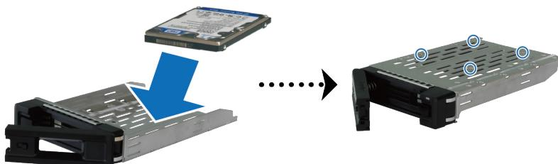
**3** 将装好硬盘的托盘置入空的硬盘插槽。
