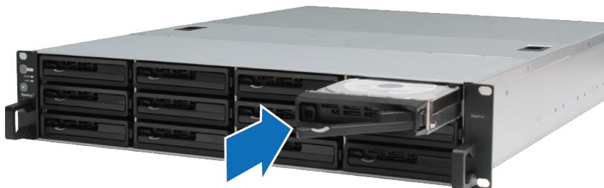
**重要事项：** 请确定硬盘托架已完全推入。否则，硬盘可能无法正确运作。
