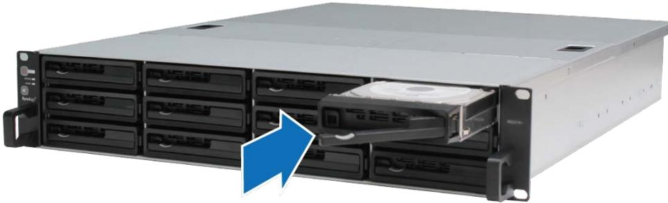
**重要：**请确定托盘已完全推入。否则，硬盘可能无法正确运作。
