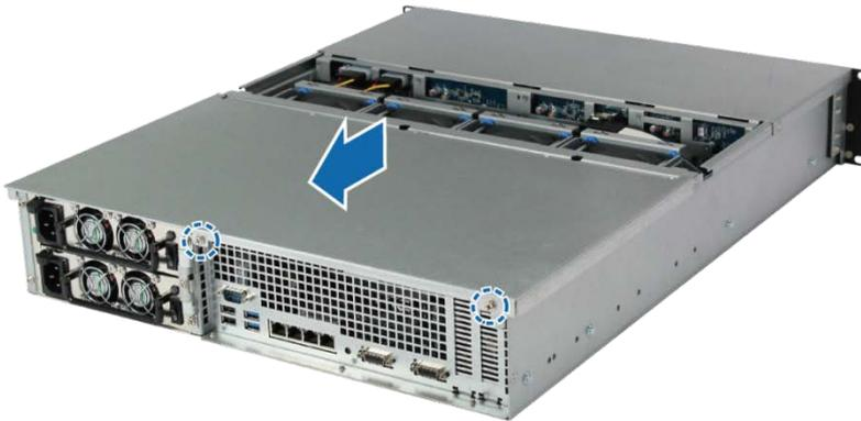
c 松开固定支撑架的螺丝，并取出支撑架露出内存插槽。
