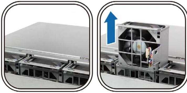
5 用力按下电源插头，并按照下图所示将其从电源端口拔除。然后将故障风扇从风扇外壳取下。
