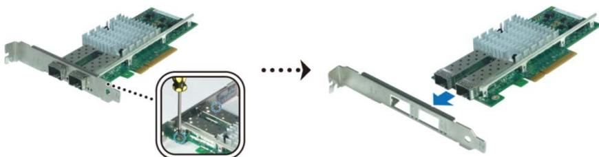
2 装上低调式支撑架并锁紧螺丝来固定。
