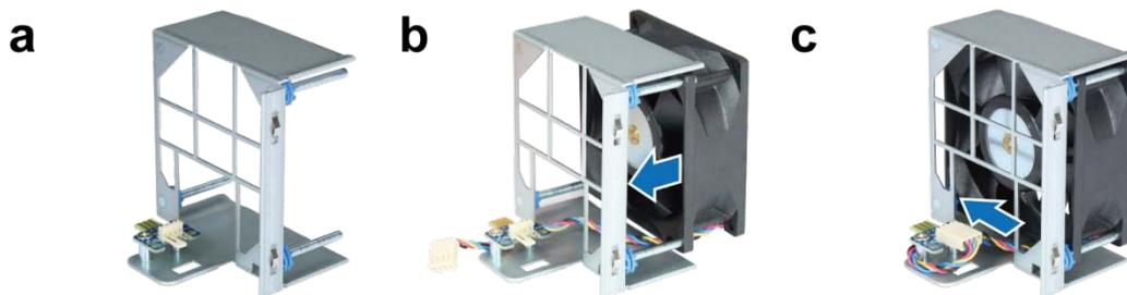
7 将完成的冷却风扇组件装入 RackStation。确认电源端口是否正确对齐。
