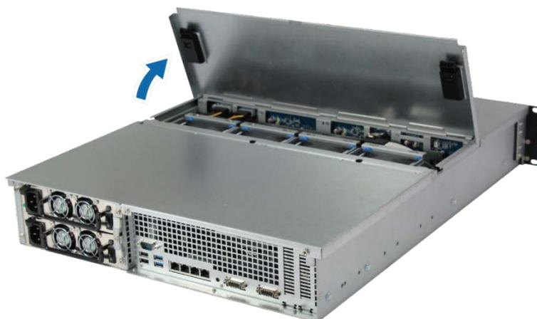
4 请按照下列步骤取下固定顶盖的螺丝：
