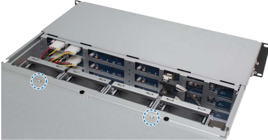
b 松开后面板上的 2 颗螺丝。按照下图指示的方向滑开顶盖并将其取下。
