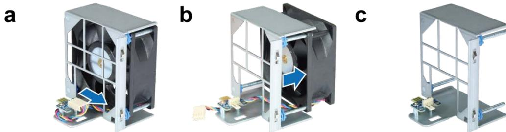
6 将新的风扇装入外壳，并将电源线插入电源端口。
