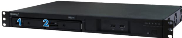
**注：**如果您想设置 RAID 装置，建议所安装的所有硬盘具有相同的尺寸，以确保最佳利用硬盘容量。
