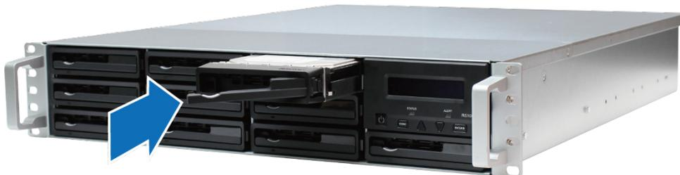
**重要事项：** 确保硬盘托盘完全插入。否则，硬盘可能无法正确运作。
