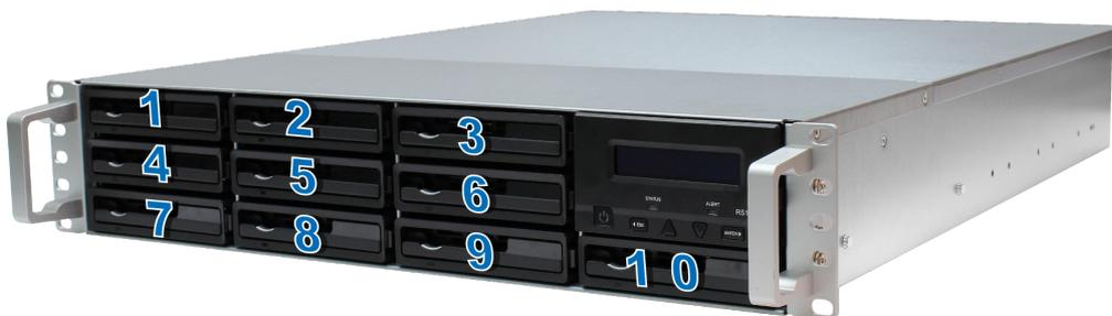
**注：** 如果您想设置 RAID 配置,建议所安装的所有硬盘具有相同的尺寸，以优化硬盘容量使用。
