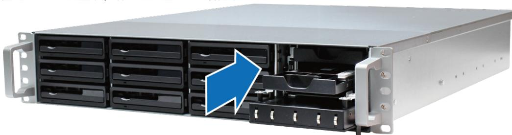
**重要事项：** 确保 SSD 托盘完全插入。否则，SSD 可能无法正确运作。
