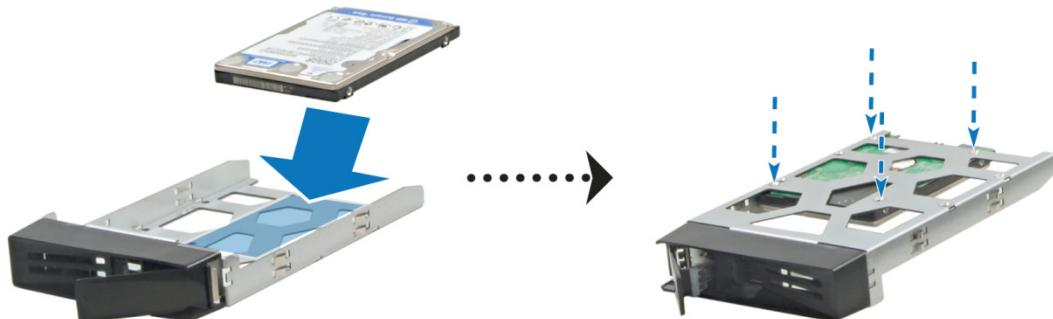
3 将装好的硬盘托盘放入空的硬盘插槽。
