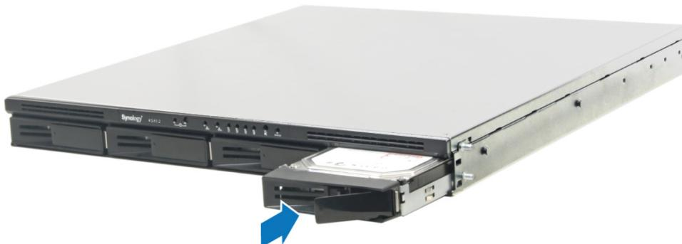
**重要事项：**请确定已将托盘完全推入。否则，硬盘可能无法正确运作。
