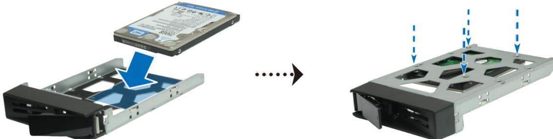
**3** 将装好的硬盘托盘放入空的硬盘插槽。
