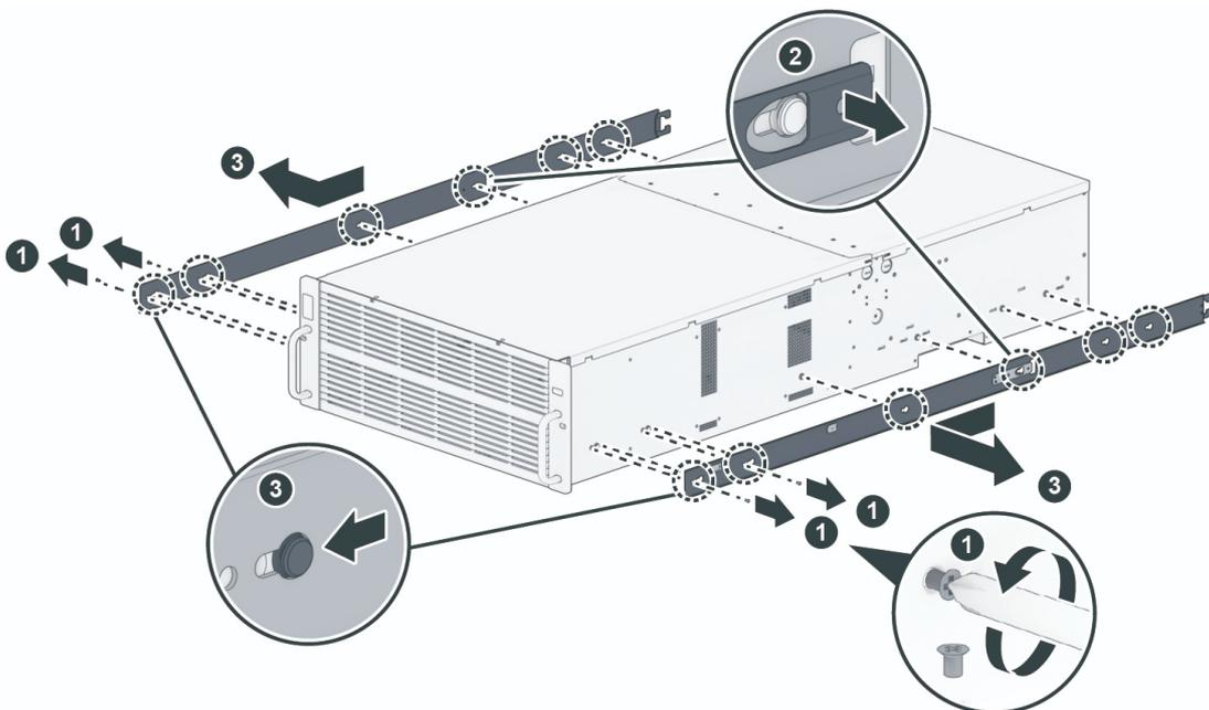
5. Sujete el pestillo trasero del raíl interior, como se muestra en la ilustración, y continúe empujando el raíl interior de nuevo en el conjunto.
