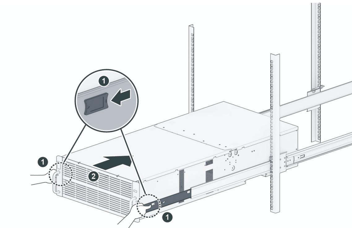
6. Empuje el chasis en el extremo del rack y utilice los tornillos 4U para fijar el chasis al rack.
