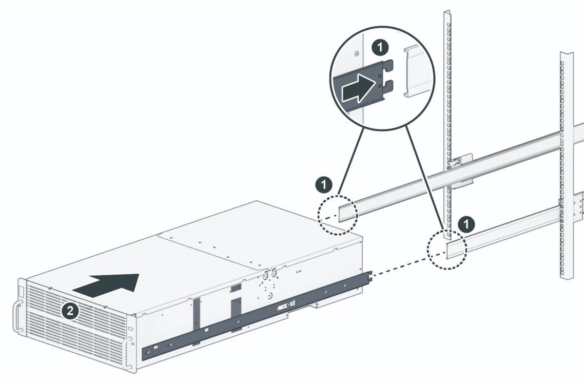
5. Tire del pestillo delantero del raíl interior, como se muestra en la ilustración, para desbloquear el raíl y siga empujando el chasis hacia el rack.
