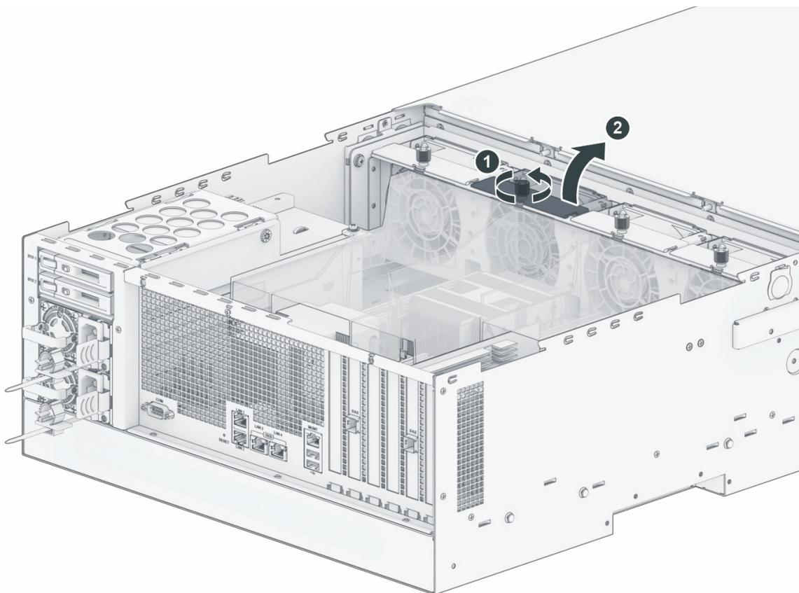
4. Prepare un nuevo ventilador e instálelo en el HD6500. Asegúrese de que el ventilador está alineado correctamente.
