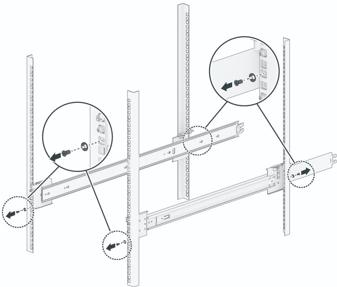
7. Extraiga los soportes como se muestra en la ilustración y deslice el pestillo delantero hacia atrás.
