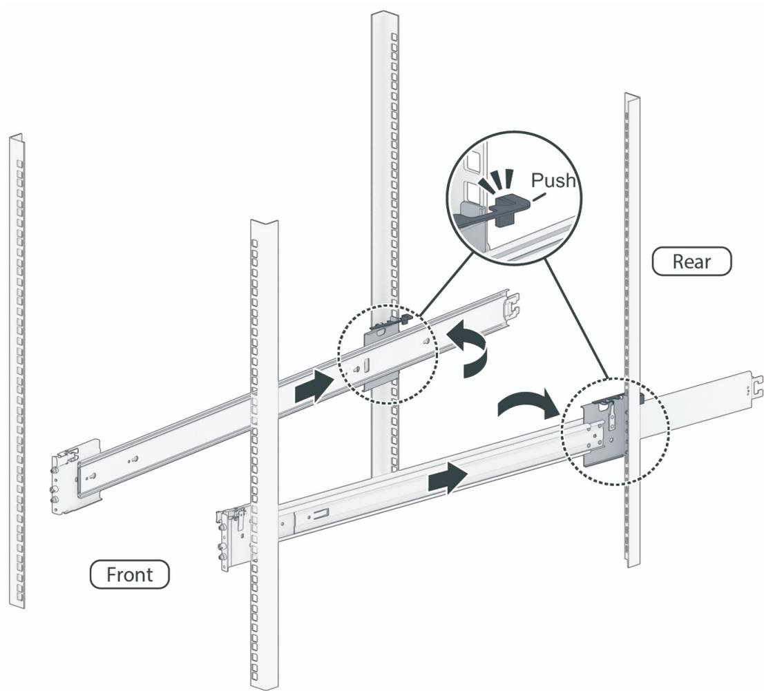
b. Deslice el pestillo delantero hacia fuera e introduzca los soportes en los orificios del rack.
