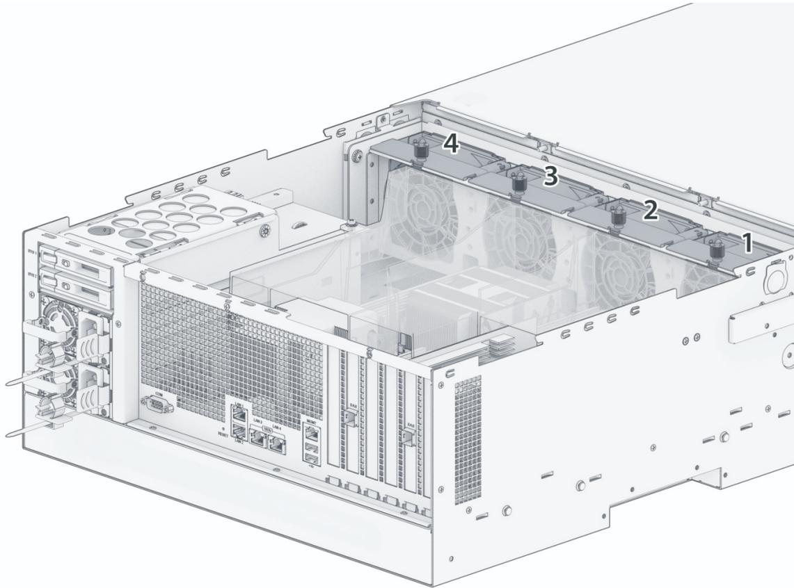
3. Busque el ventilador defectuoso. Levante el ventilador para extraerlo.
