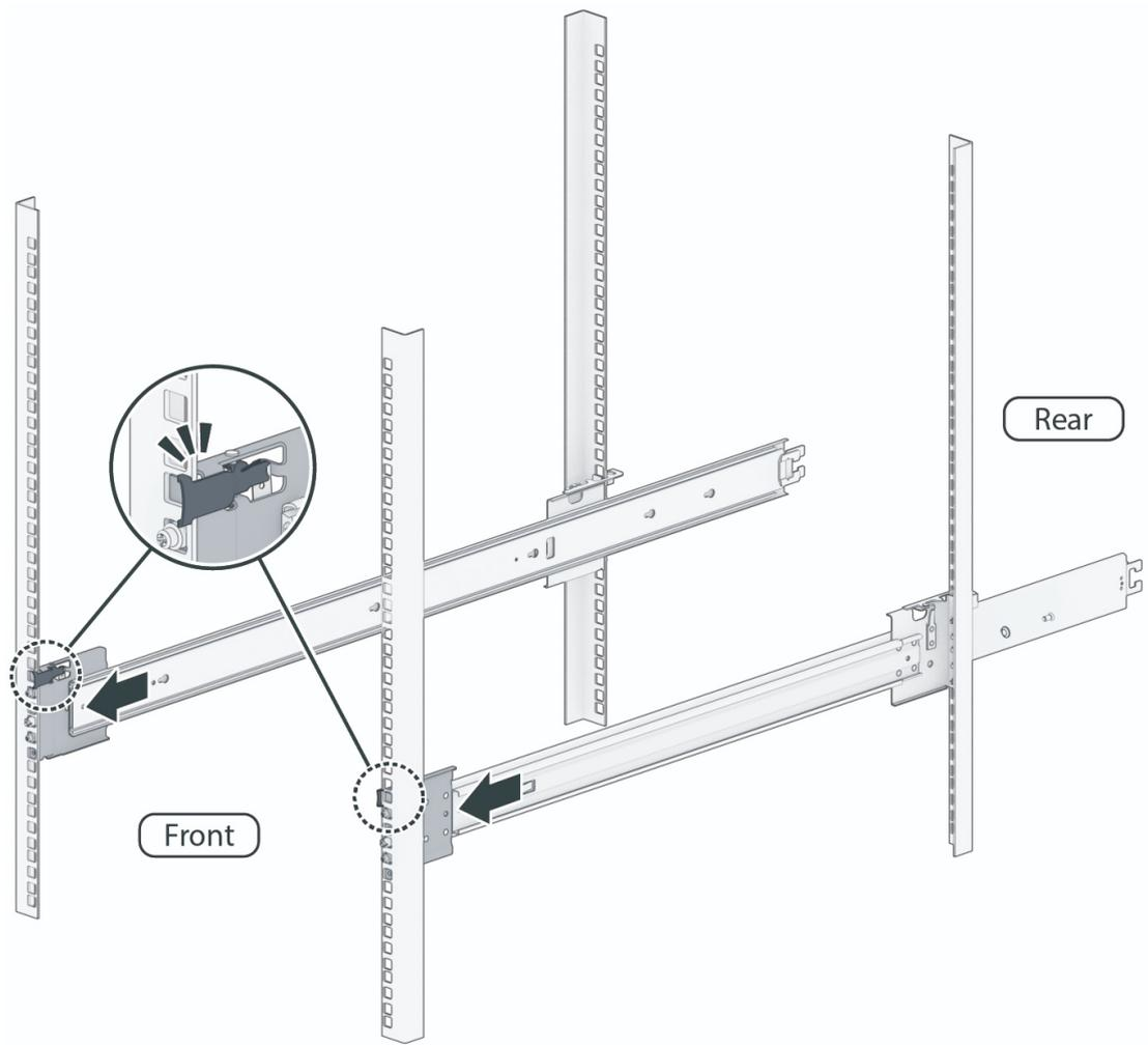
c. Fije los tornillos del raíl e instale las tuercas enjauladas como se muestra en la ilustración.
