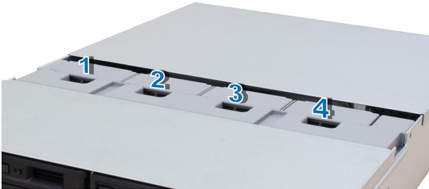
4 Busque el ventilador defectuoso. Levante el ventilador para retirarlo.
