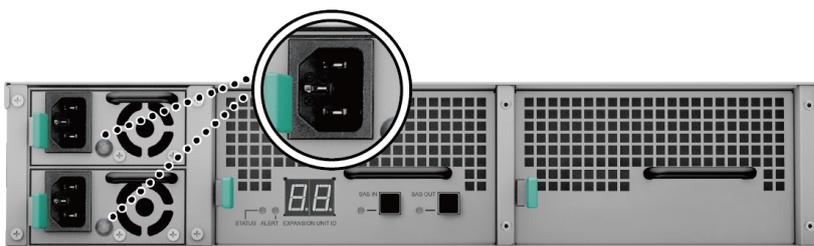
**Observación:** La unidad RX1217sas/RX2417sas está equipada con un sistema de fuente de alimentación redundante que permite conectar dos cables de alimentación. Es posible alimentar el sistema con un solo cable de alimentación, pero se recomienda usar dos cables de alimentación para evitar cortes eléctricos inesperados.
