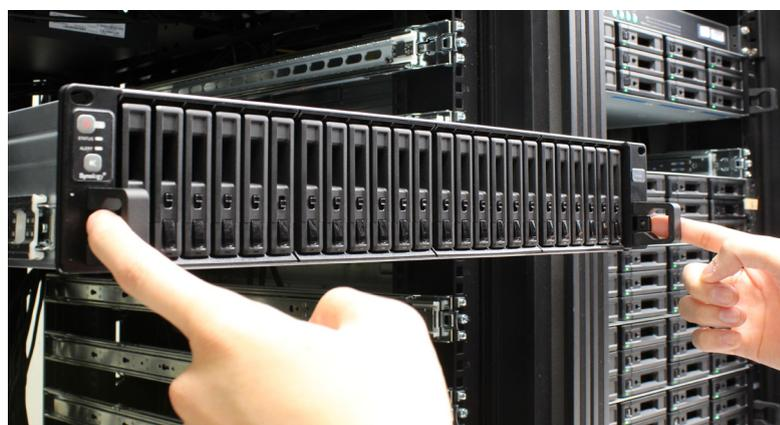
2 在他人的帮助下，小心地从机架中卸下机箱。然后向前滑动以从机箱中卸下内部导轨。
