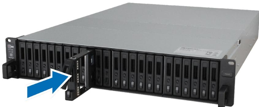
**注：**请确定将托盘完全推入。否则，硬盘可能无法正常工作。
