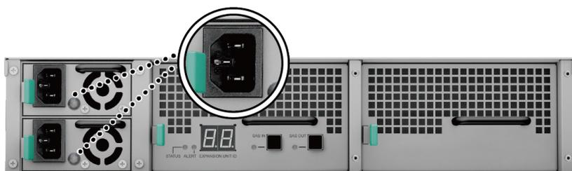
**注：** RX1217sas/RX2417sas 配有冗余电源系统，可以连接两根电源线。系统可以仅用一根电源线启动，但是推荐使用两根以避免意外断电。
