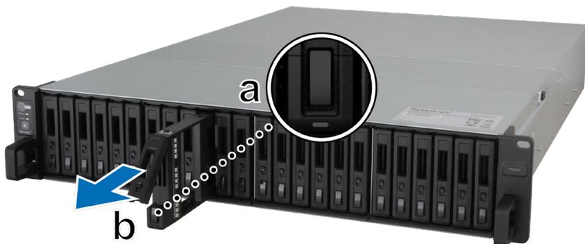
**a** 找到硬盘托盘把手底部的小按钮。按下按钮，硬盘托盘把手将弹出。
