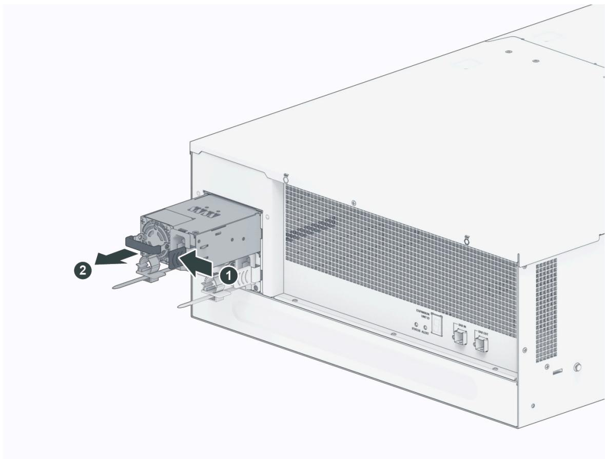
3. 新しいPSUを準備します。カチッという音が聞こえるまで空のスロットに挿入します。
