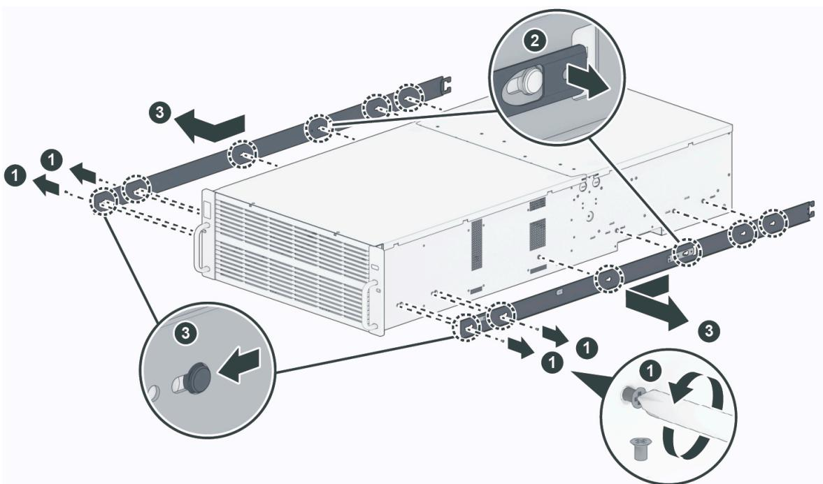
5. 図のように、リアラッチを内部レール上に保持し、内部レールをアセンブリに押し戻します。
