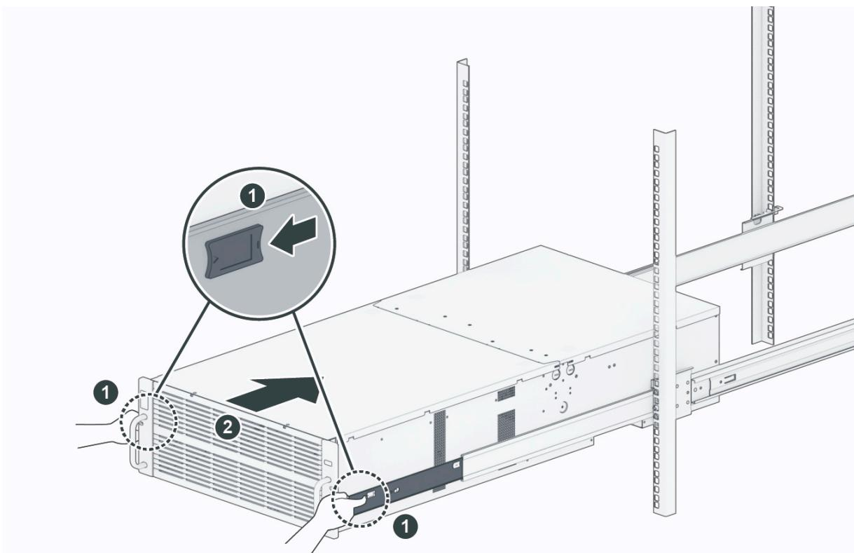
6. シャシーをラックの端に押し、4Uネジを使ってシャシーをラックに固定します。
