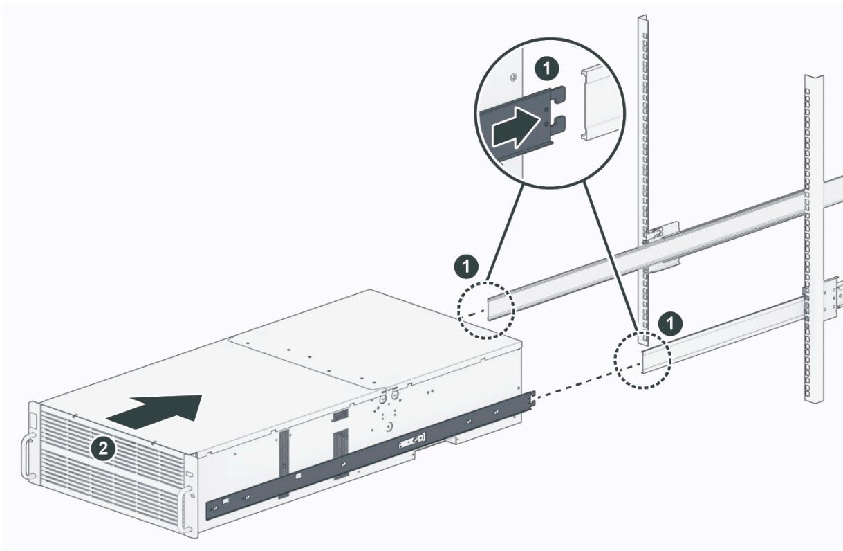
5. 図のように内部レールの前面ラッチを引いて内部レールのロックを解除し、シャシーをラック方向に押し続けます。
