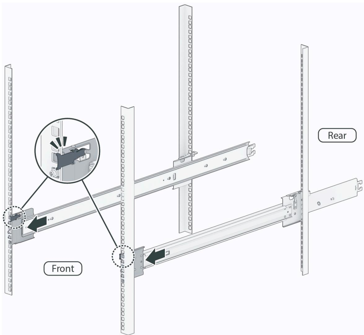
c. レールのネジを締め、ケージナットを図のように取り付けます。
