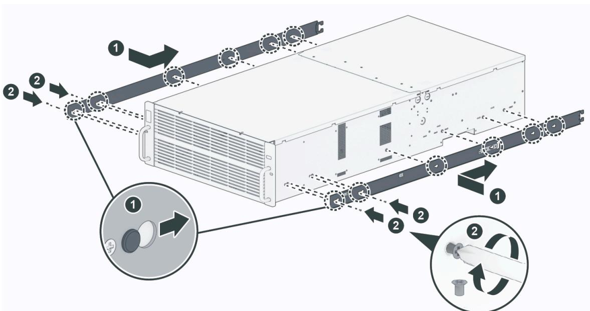
4. 他の人の助けを借りて、内部レールを外部レールに合わせ、シャシーをラックに向けて押します。
