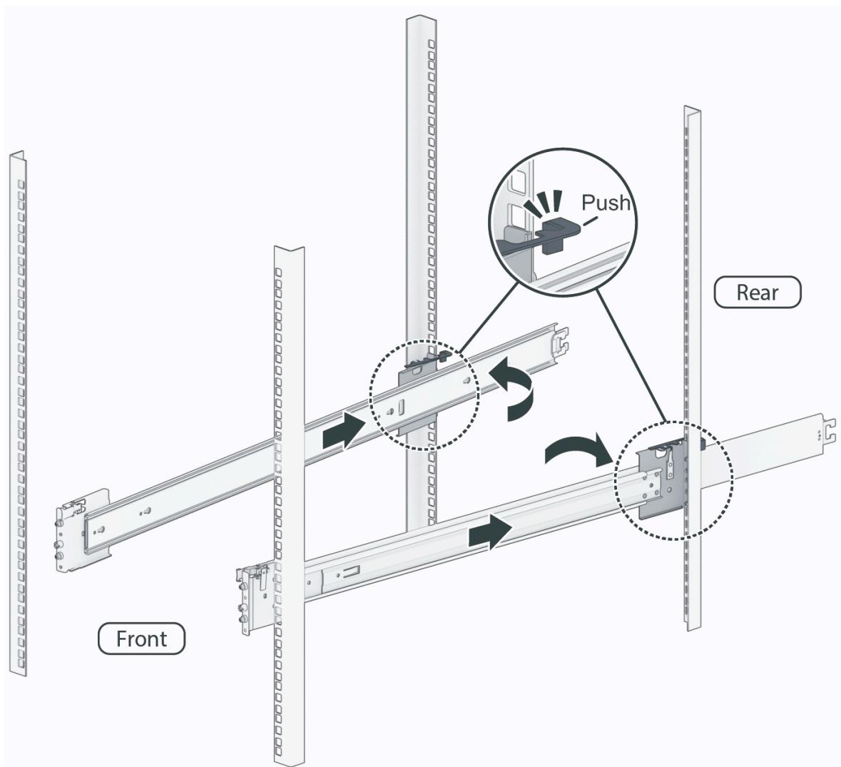
b. 前面のラッチを外側にスライドさせて、ブラケットをラック穴に挿入します。
