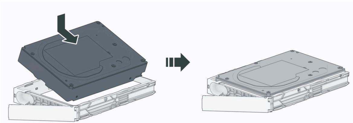
4. ドライブを載せたドライブトレイを空のドライブベイに挿入します。
