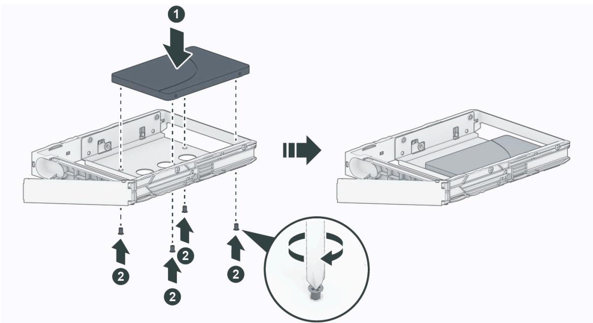
。3.5インチドライブの場合：ドライブトレイにドライブを置きます。
