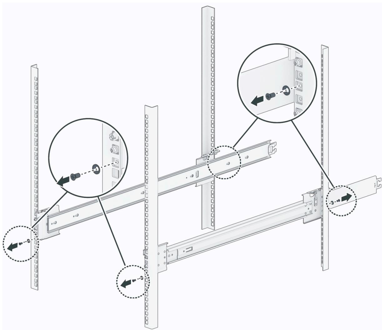
7. ずのように金具を引き抜き、前面ラッチを後方にスライドさせます。
