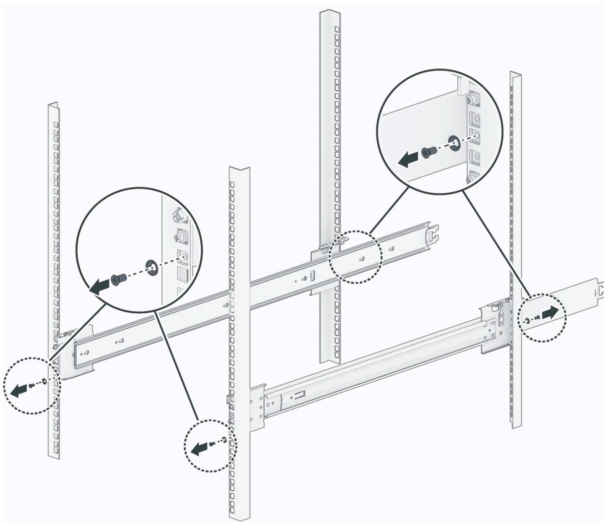
7. Ziehen Sie die Halterungen wie unten gezeigt heraus und schieben Sie den vorderen Riegel nach hinten.
