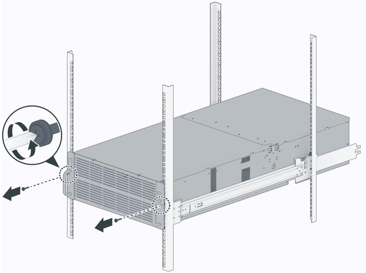
2. Ziehen Sie das Gehäuse aus dem Rack heraus.
