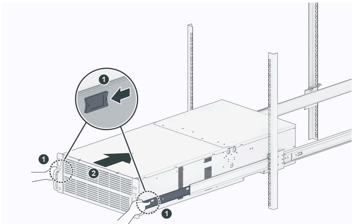
6. Schieben Sie das Gehäuse bis zum Anschlag in das Rack und befestigen Sie das Gehäuse mit den 4U-Schrauben am Rack.
