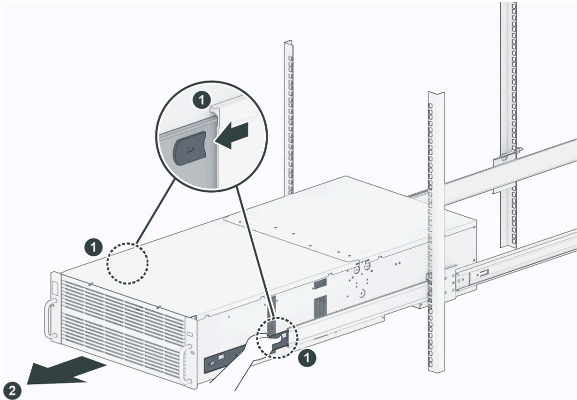
4. Entfernen Sie die Rackschienen von der Expansionseinheit:
