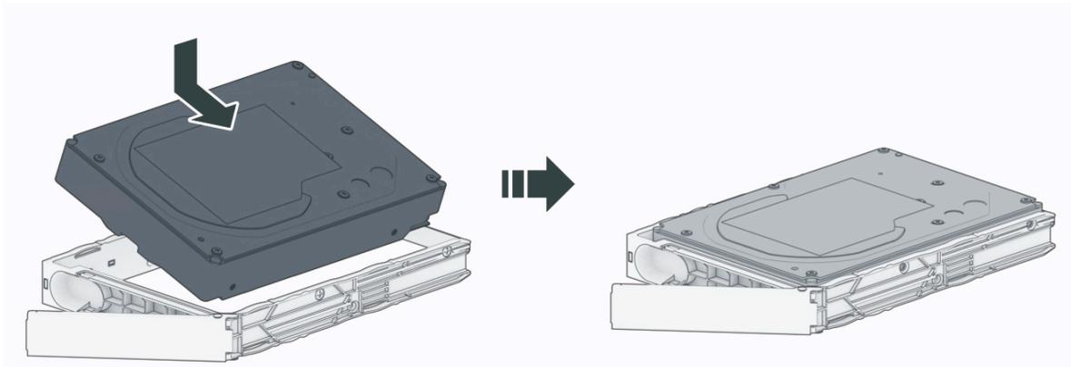
4. Setzen Sie den Laufwerkträger mit dem Laufwerk in den leeren Einschub ein.
