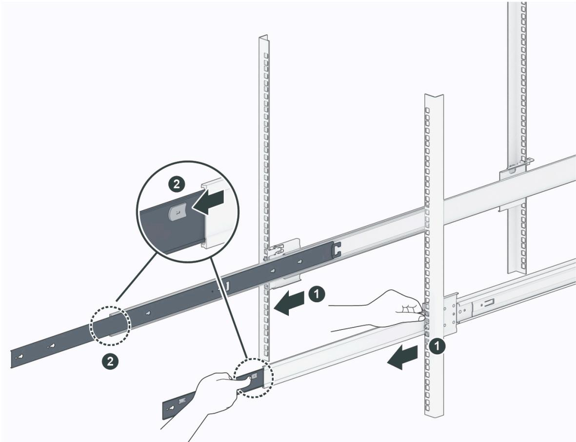
3. Die Rackschienen an der Expansionseinheit befestigen:
