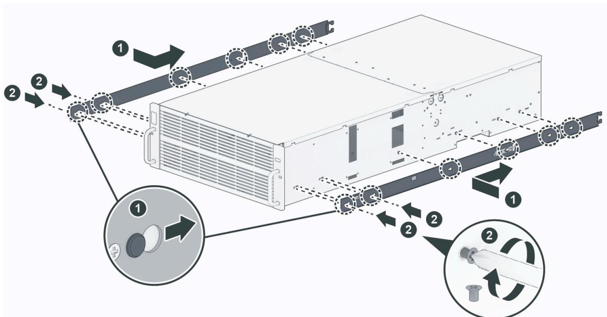
4. Richten Sie mithilfe einer zweiten Person die inneren Schienen vorsichtig an den äußeren Schienen aus und schieben Sie das Gehäuse in das Rack.
