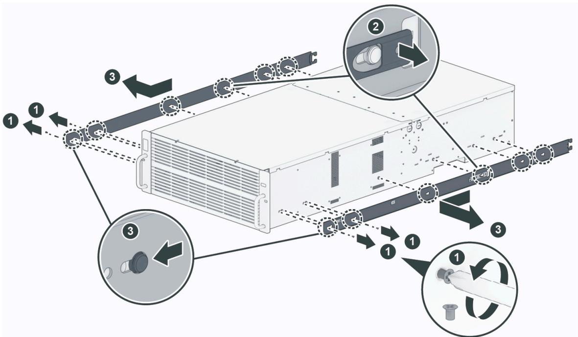
5. Halten Sie den hinteren Riegel auf der inneren Schiene wie unten gezeigt, und schieben Sie diese wieder in die Baugruppe hinein.
