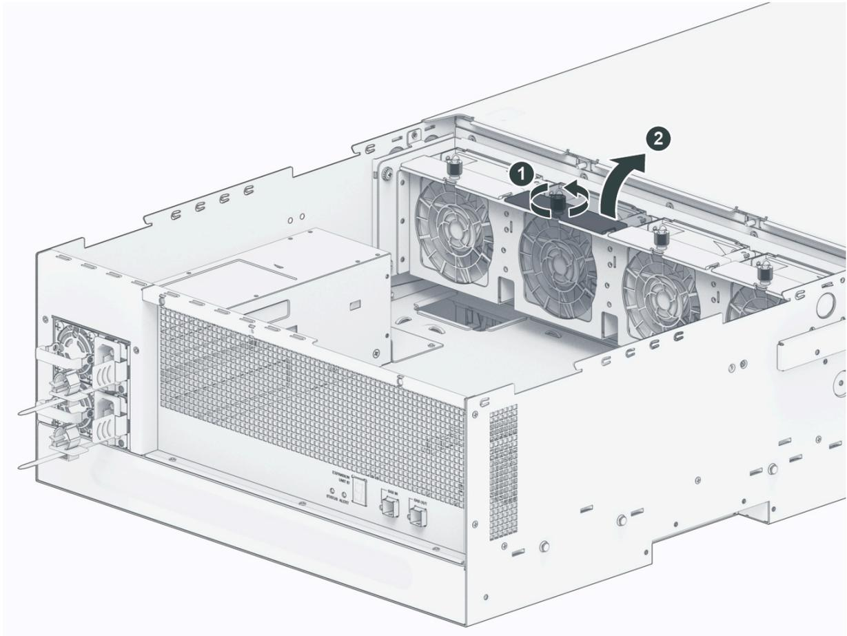
4. Bereiten Sie einen neuen Lüfter vor und setzen Sie ihn in die RX6025sas ein. Stellen Sie sicher, dass der Lüfter korrekt ausgerichtet ist.
