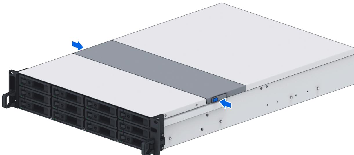
2. Levante para quitar la cubierta del ventilador
