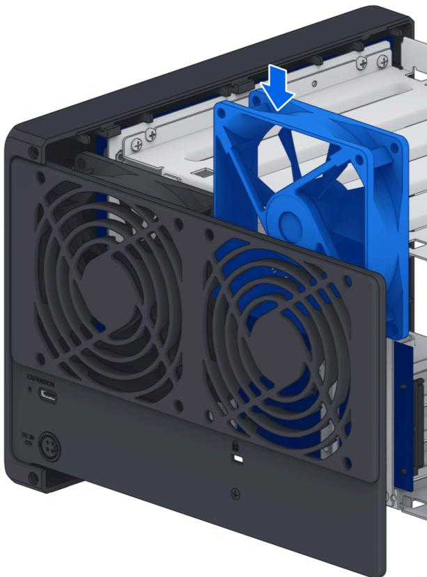
3. Установите винты задней панели и подключите разъемы вентилятора в соответствующие слоты, как показано ниже.
