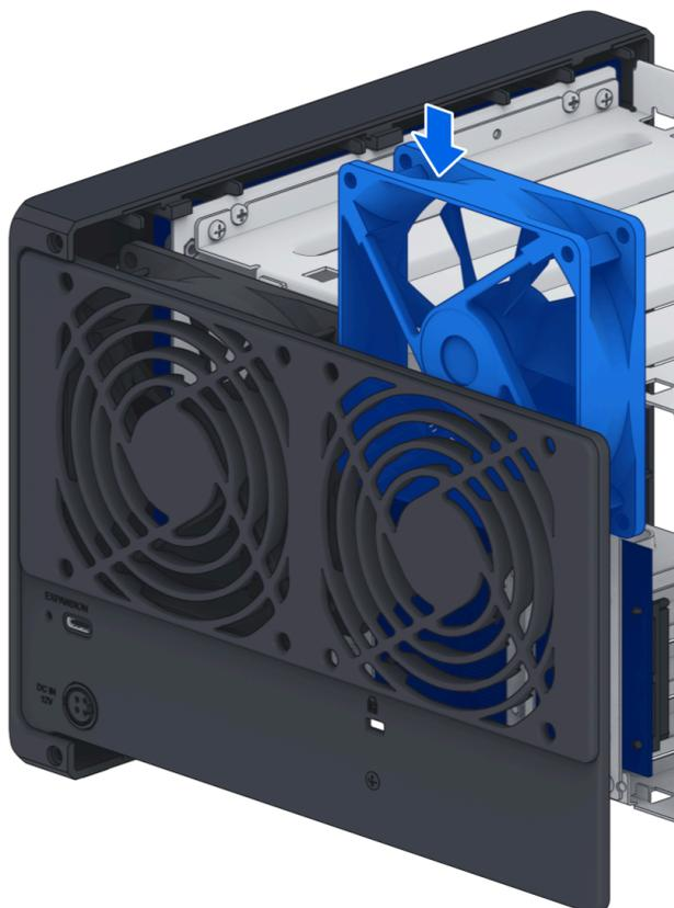
3. Installieren Sie die Rückplattenschrauben und verbinden Sie die Lüfteranschlüsse in ihrem entsprechenden Steckplatz wie unten gezeigt.
