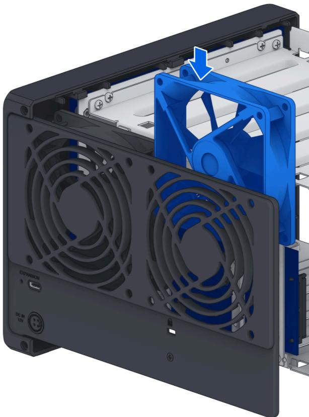
3. 安装背板螺丝并将风扇连接器连接到其对应的插槽，如下图所示。
