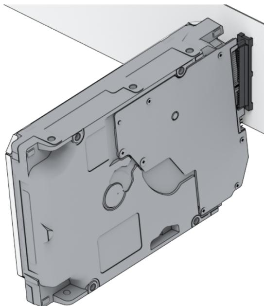
3. Remplacez le disque dur par un nouveau, puis redémarrez le Synology NAS pour voir si le problème est causé par le disque retiré.
