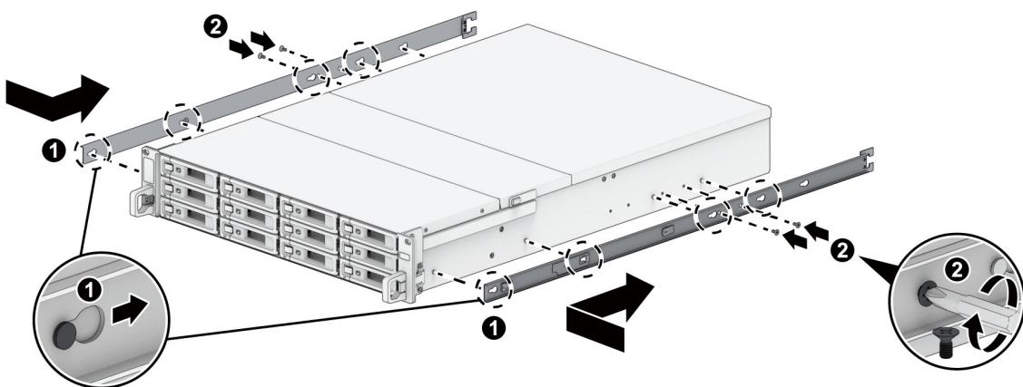
5 在他人的帮助下，小心地将内部导轨与外部导轨组件对齐，然后将机箱推向机架。
