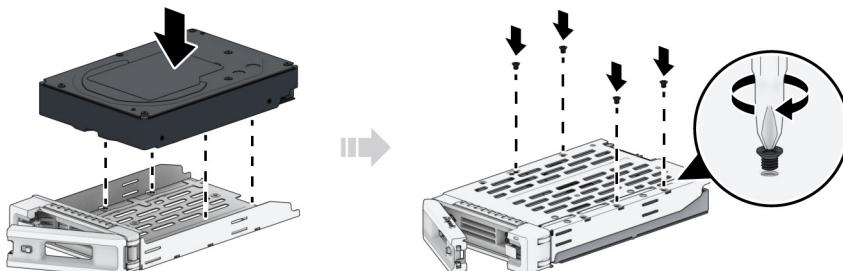
**②对于 2.5 英寸硬盘：**将硬盘置于硬盘托盘中。将托盘翻转朝下，然后拧紧螺丝来将硬盘固定到位。
