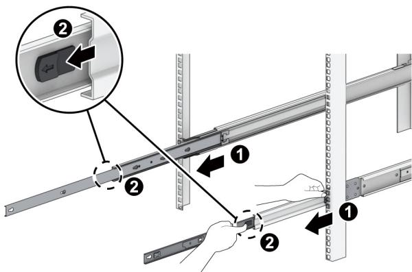
**4** 将导轨套件连接到扩充设备：
