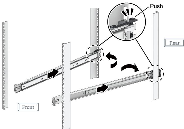
**②** 向外滑动前卡榫，然后将支架插入机架孔中。
