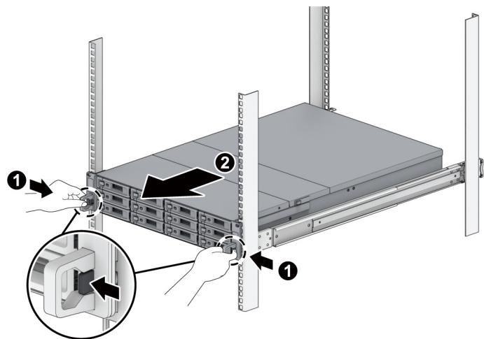
2 在他人的帮助下，小心地从机架中卸下机箱。然后，将连接到机箱的内部导轨滑向机箱前面板以使其分离。
