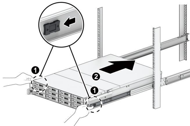
7 将机箱推入机架末端。如有必要，请使用导轨套件包装附带的锁紧螺母和螺丝将机箱固定到机架上。
