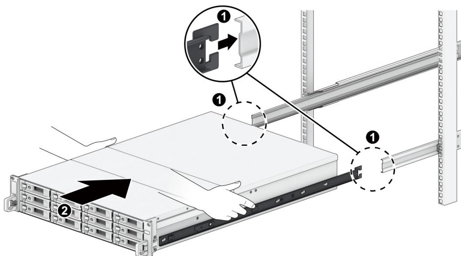
6 如图所示，拉动内部导轨的前卡榫以解锁内部导轨，并继续将机箱推向机架。
