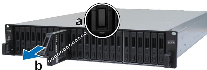
**a** Busque el botón pequeño ubicado en lateral inferior del asa de la bandeja del disco duro. Pulse el botón y el asa de la bandeja de discos.
