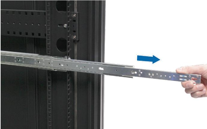
3 Alinee los orificios de fijación del raíl interior con los puntos de fijación del lateral del chasis. Deslice el raíl interior hacia fuera del panel frontal para fijarlo al chasis.
