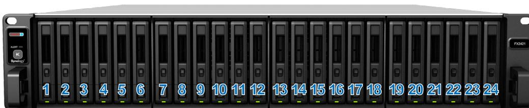
**Anmerkung:** Wir empfehlen, Laufwerke derselben Größe zu installieren, um die Laufwerkskapazität beim Erstellen von RAID-Volumes optimal zu nutzen.
