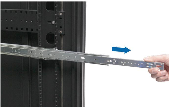
3 Richten Sie die Befestigungslöcher der inneren Schiene auf die Befestigungspunkte an der Gehäuseseite aus. Schieben Sie die innere Schiene von der Vorderseite weg, um sie am Gehäuse zu befestigen.
