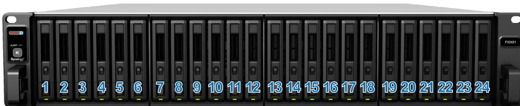
**注意：**建議您在建立 RAID 儲存空間時，安裝相同容量的硬碟以將容量使用最佳化。
