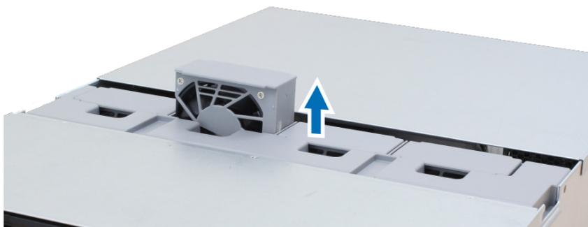
5 準備好新的風扇，並裝入 FX2421。確認風扇已依下圖所示方向安裝。
