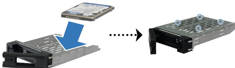
3 Inserire il vano dell'unità caricata nel vano vuoto dell'unità.
