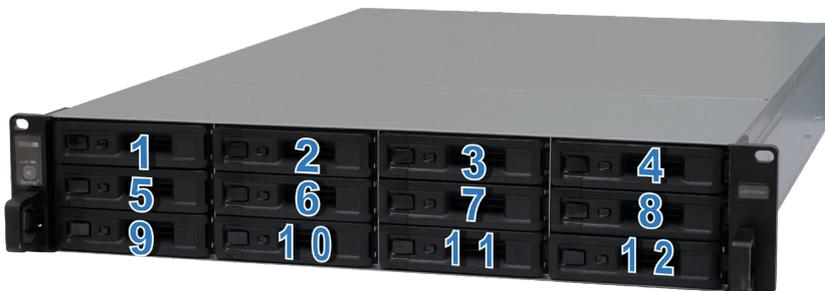
**Nota:** Si consiglia di installare unità delle stesse dimensioni per ottimizzare l'uso della capacità dell'unità quando si creano volumi RAID.
