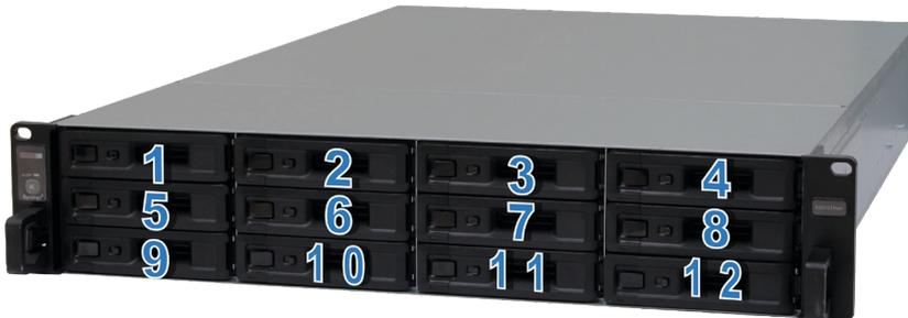
**Anmerkung:** Wir empfehlen, Laufwerke derselben Größe zu installieren, um die Laufwerkskapazität beim Erstellen von RAID-Volumes optimal zu nutzen.
