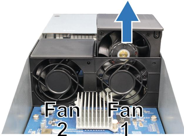
2 Bereiten Sie einen neuen Lüfter vor, richten Sie den Pfeil wie nachstehend gezeigt auf die Rückseite aus und setzen Sie den Lüfter wieder in den Lüftersteckplatz ein.
