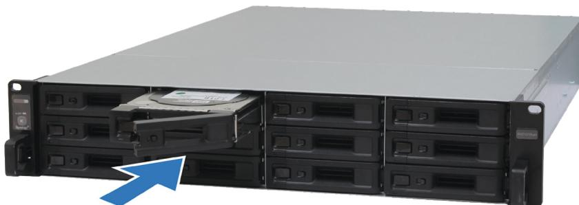
**注：**请确定将托盘完全推入。否则，硬盘可能无法正常工作。
