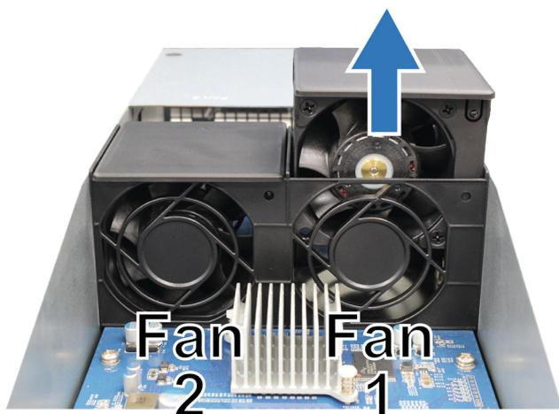
2 准备好新的风扇，按下图将箭头对准后侧面板，将其插回风扇插槽。
