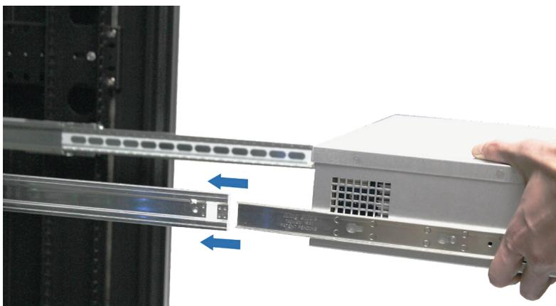
5 将机箱推向机架。如有必要，请使用导轨套件包装中的锁紧螺母和螺丝将机箱固定到机架上。
