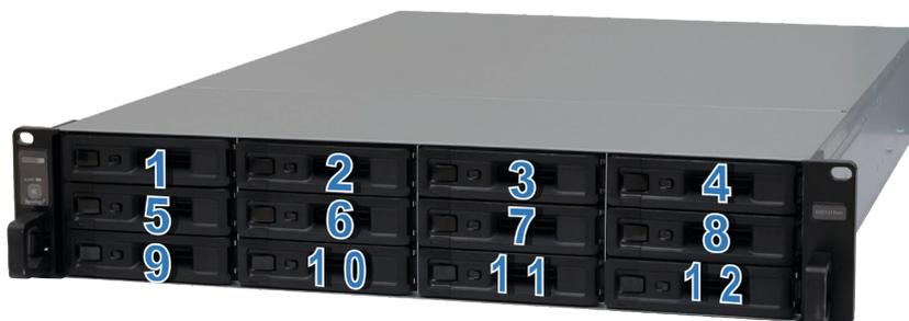
**注：**建议安装大小相同的硬盘，以便在创建 RAID 存储空间时优化硬盘容量使用。
