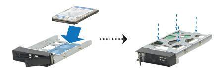
3 Inserte la bandeja de discos cargada en el receptáculo de unidades vacío.
