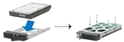
Para discos de 2,5": Coloque los discos en la bandeja de discos. Dé la vuelta a la bandeja y apriete los tornillos en los cuatro puntos que se indican a continuación para fijar el disco.
