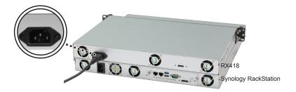
2 Conecte un extremo del cable de expansión a la unidad de expansión y el otro extremo a la unidad RackStation principal.
