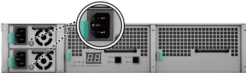
**Nota:** La unidad RX2417sas está equipada con un sistema de fuente de alimentación redundante que permite conectar dos cables de alimentación. Es posible alimentar el sistema con un solo cable de alimentación, pero se recomienda usar dos cables de alimentación para evitar cortes eléctricos inesperados.
