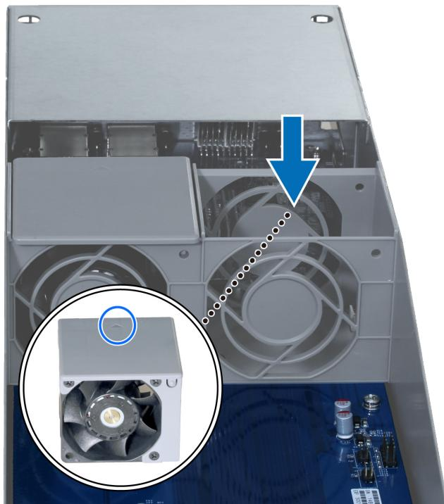
3 Вставьте модуль обратно в устройство расширения и надавите до щелчка.
