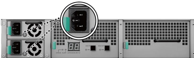
**Nota:** Seu RX2417sas vem equipado com um sistema redundante de fonte de alimentação, o que permite que dois cabos de alimentação sejam conectados. O sistema pode ser ligado com apenas um cabo de alimentação, mas recomendamos o uso de dois cabos para evitar falhas de energia inesperadas.
