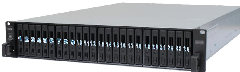
**Nota:** per creare un volume RAID, si consiglia di installare tutte le unità delle stesse dimensioni in modo da ottimizzare l'utilizzo della capacità dell'unità.
