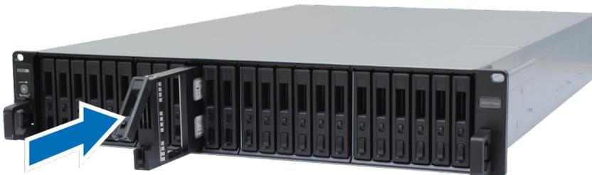
**Anmerkung:** Achten Sie darauf, dass der Einschub vollständig hineingeschoben ist. Ansonsten funktioniert das Laufwerk möglicherweise nicht korrekt.
