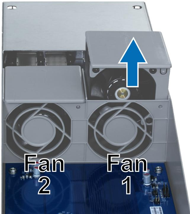
**2** 准备好新的风扇，按下图将箭头对准后侧面板，将其插回风扇插槽。
