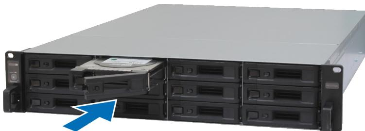
**Примечание.** Убедитесь, что лоток задвинут до упора. В противном случае в работе диска могут возникнуть неполадки.
