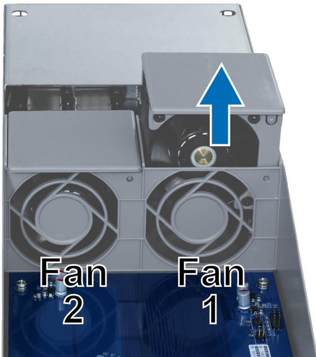
2 Подготовьте новый вентилятор, поверните его так, чтобы стрелка указывала на заднюю панель (как показано на рисунке ниже), и вставьте в разъем вентилятора.
