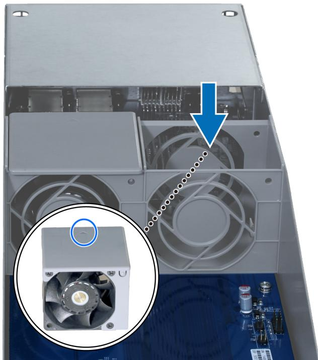
3 Вставьте модуль обратно в модуль расширения и надавите до щелчка.
