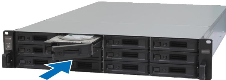
**注：**请务必将托盘完全推入。否则，硬盘可能无法正常运作。
