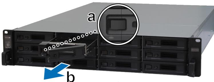
a 找到硬盘托盘把手左侧的小按钮。按下按钮，硬盘托盘把手将弹出。
