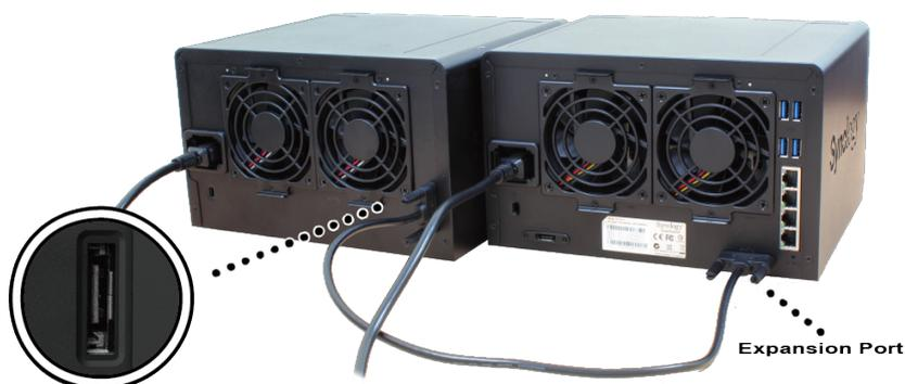
Une fois la connexion établie, le DX517 est mis automatiquement sous ou hors tension lorsque le DiskStation connecté est mis sous ou hors tension.
