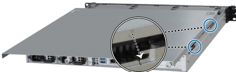
b Aperte os dois parafusos que desapertou no passo 2-a.
