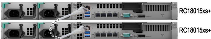
3 分別在 RackStation 及擴充裝置上，將電源線的一端接上電源埠，另一端接上電源插座。
