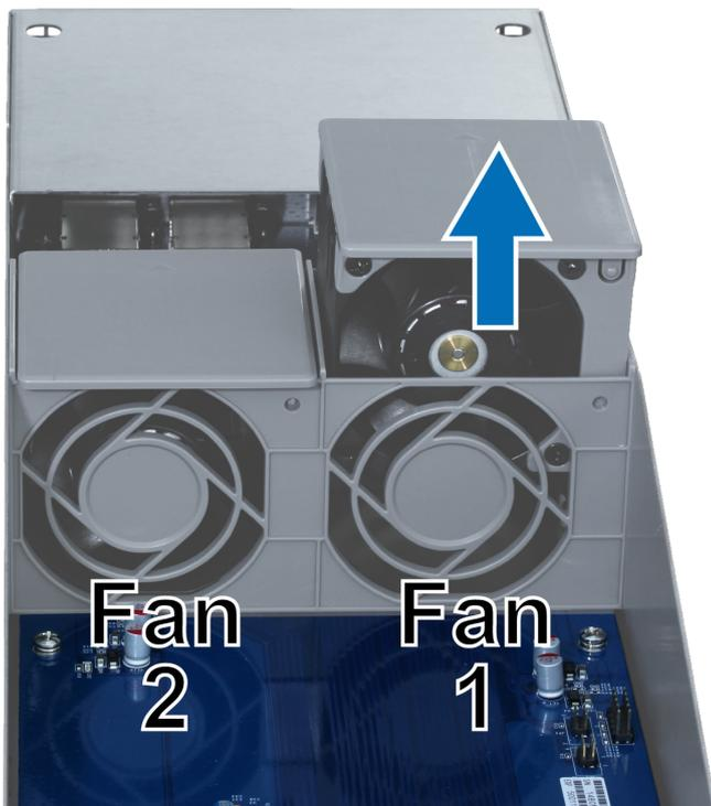
2 預備全新的風扇，將箭頭對準後方面板 (如下圖所示)，並將風扇插進插槽內。
