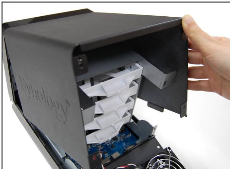
8. 将固定卡钩固定到后面板上的孔位。确定在后面板的内面，固定卡钩已勾上。
