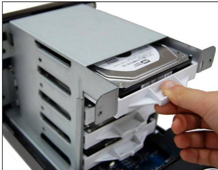
6. 如果您使用 3.5 吋硬盘，用附上的机壳螺丝将硬盘盘锁紧。
