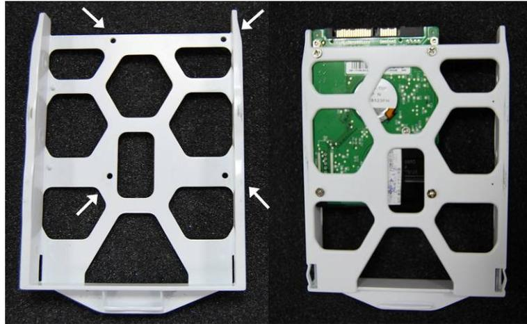
5. 将所有硬盘依上述方法锁紧，再将硬盘放回机器，并确实推入至底。
