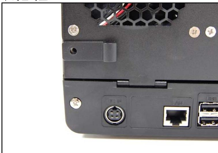
9. 阖上后面板，然后将四颗固定后面板的螺丝锁回。
