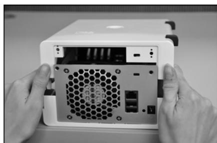
4. 将连接较短硬盘数据排线的硬盘放到硬盘支架上。这颗硬盘会是一号磁盘（**disk#1**）。
