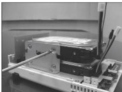
8. 将硬盘数据排线和硬盘电源线正确地依照磁盘号码接上主机板。
