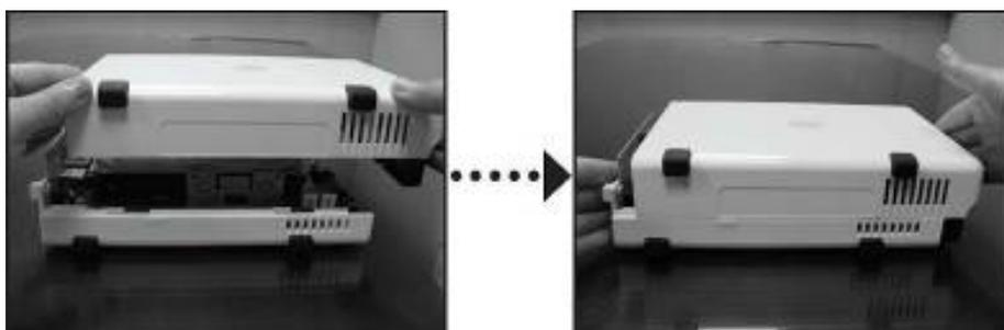
7. 使用两颗机壳螺丝将后面板锁紧。
