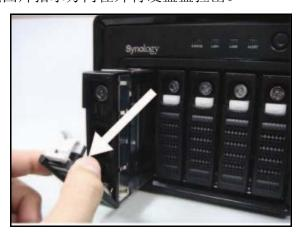
3. 将准备好的 SATA 硬盘装进硬盘盘,并依照下图指示的螺丝位置将 四颗螺丝锁上。
