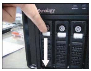
2. 依照图片指示方向往外将硬盘盘拉出。
