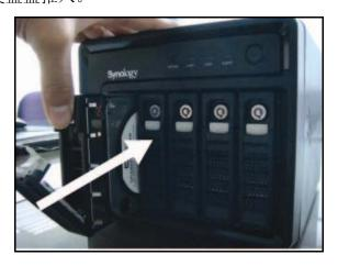
备注:请将硬盘盘推入至底,确实将硬盘盘与主机接上。
