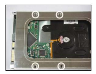
4. 硬盘排序如下图所标示,由左至右为 HDD1, HDD2, HDD3, HDD4, 和 HDD5。
