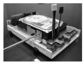
7. 将硬盘数据排线和硬盘电源线接上主机板。(若您的 Disk Station 为无排线版本,请略过本步。)
