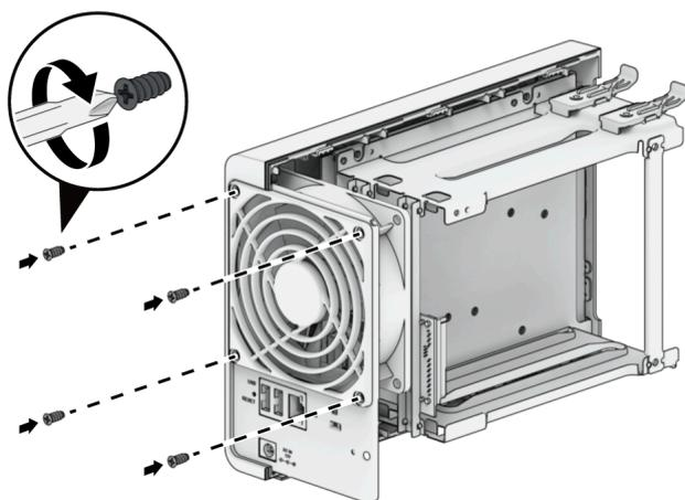
3. Enchufe el conector del ventilador y vuelva a poner la cinta a los cables.
