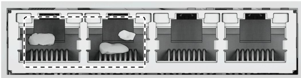
6. Revise el interior del puerto de red para ver si hay clavijas dañadas o torcidas.
