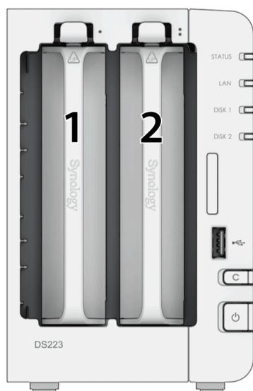
9. Vuelva a colocar la cubierta de receptáculos de discos duros para finalizar la instalación.
