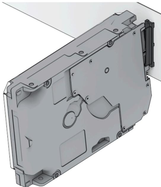
3. Reemplace el disco duro por uno nuevo y, a continuación, reinicie Synology NAS para comprobar si la unidad extraída era la causa del problema.
