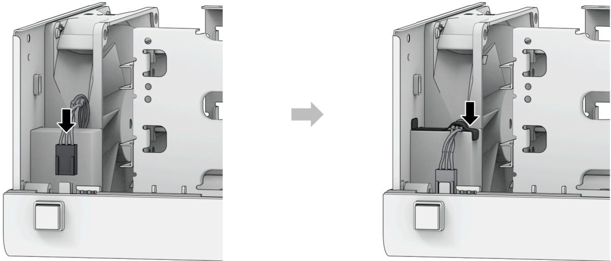
4. Vuelva a instalar el protector y sus tornillos.
