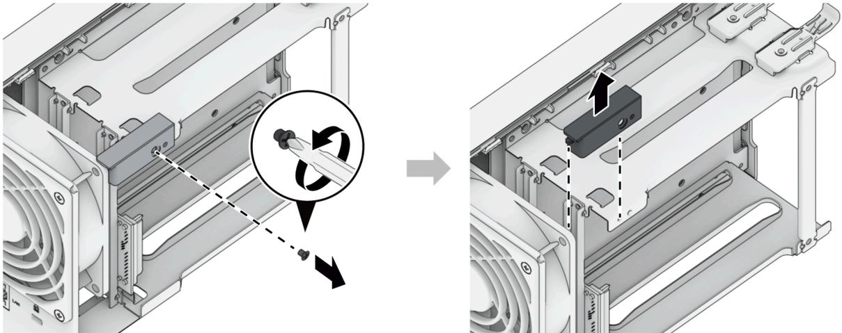
5. Retire los dos tornillos (uno en la parte posterior, el otro en la parte inferior de su Synology NAS) así como el protector.
