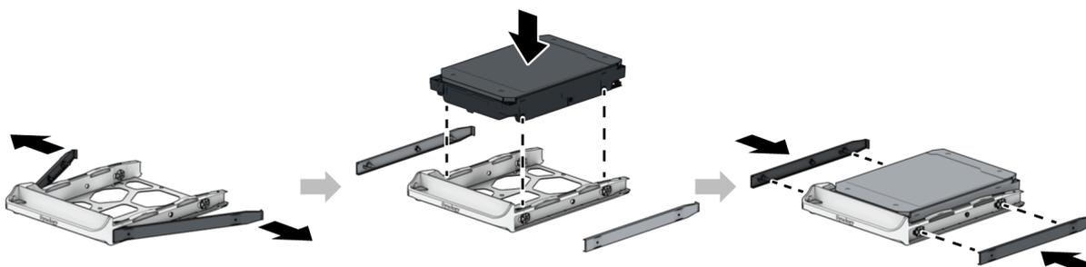
5. Para unidades de 2,5": Retire los paneles de fijación de los laterales de la bandeja de discos y guárdelos en un lugar seguro. Coloque el disco en el área de la bandeja de discos indicada más abajo, dé la vuelta a la bandeja y apriete los tornillos proporcionados para fijar el disco en su sitio.
