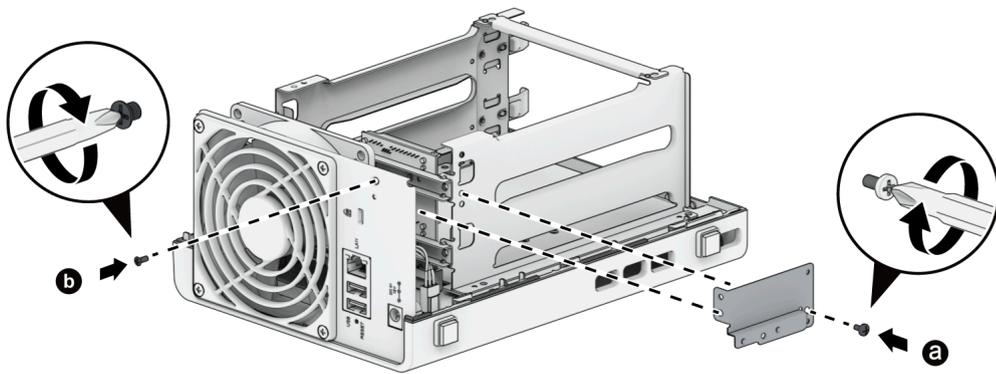
5. Vuelva a instalar el soporte de plástico del ventilador y su tornillo.
