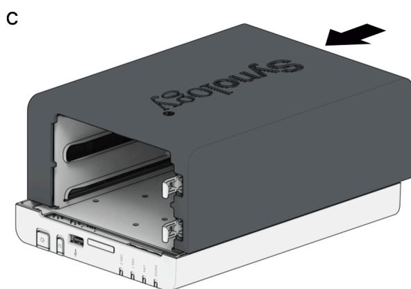
7. Vuelva a instalar las bandejas para discos y la cubierta frontal.
