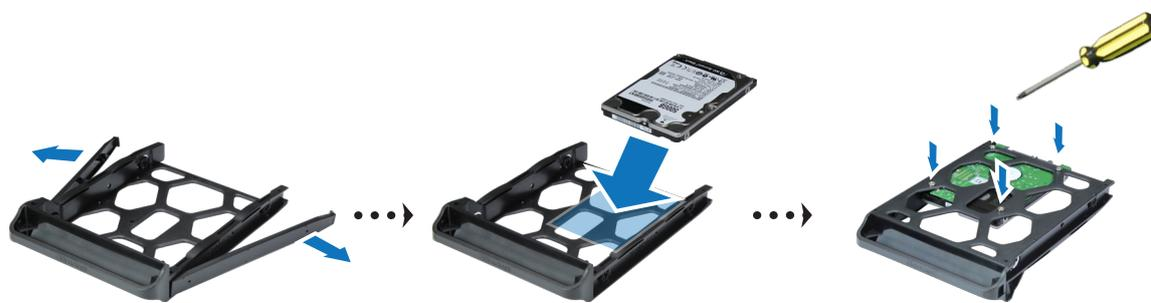
4 Inserire il vano unità caricata nell'alloggiamento vuoto dell'unità. Verificare che il lato contrassegnato con "SU" sia rivolto verso l'alto e inserire il vano unità nell'alloggiamento vuoto. A inserimento completo si dovrebbe sentire un clic.
