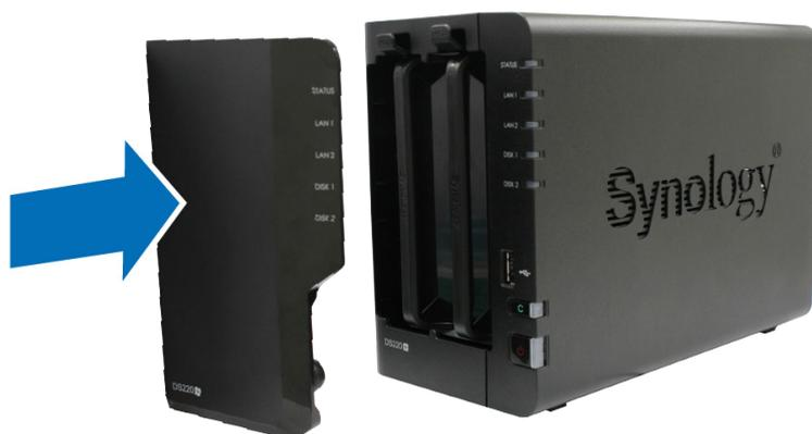
**Nota:** per creare un volume RAID, si consiglia di installare unità di dimensioni identiche per utilizzare al meglio le relative capacità.
