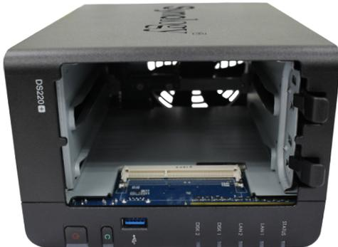
**Anmerkung:** Durch Entfernen der Laufwerkträger werden empfindliche interne Komponenten freigelegt. Berühren Sie beim Entfernen oder Hinzufügen von Speicher ausschließlich die Speicherbauteile.
