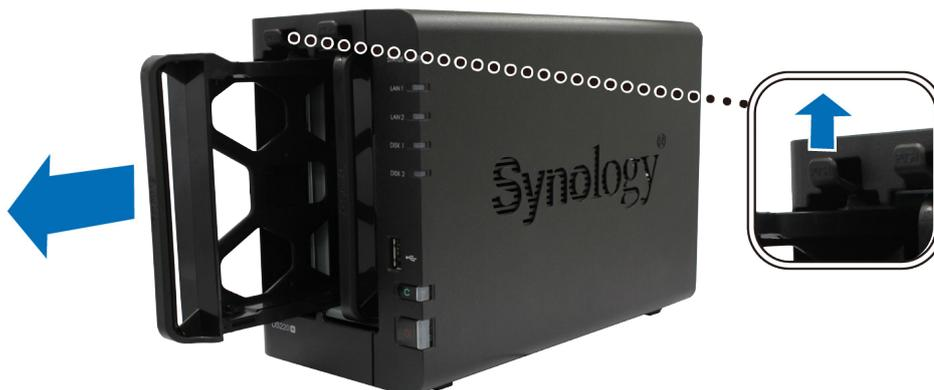
3 Legen Sie die Laufwerke in die Laufwerkträger ein.
