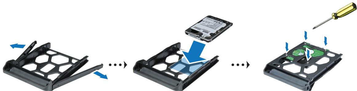
4 Setzen Sie den Laufwerkträger mit dem Laufwerk in den leeren Einschub ein. Achten Sie darauf, dass die mit „UP“ markierte Seite nach oben zeigt, und stecken Sie den Laufwerkträger in den leeren Einschub ein. Wenn der Träger korrekt eingesetzt ist, sollten Sie ein Klicken hören.
