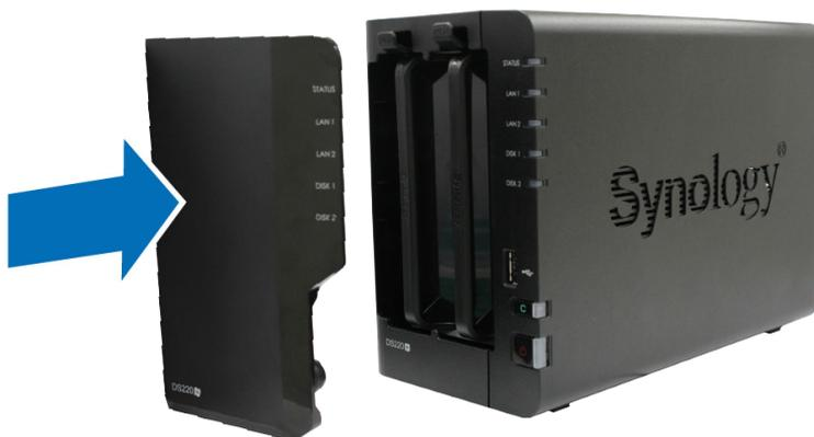
**Anmerkung:** Für die Einrichtung eines RAID-Volumens wird empfohlen, Laufwerke mit gleicher Größe zu installieren, um ihre Kapazität optimal auszunutzen.
