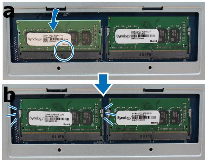
**Wichtig:** Sie müssen für alle Steckplätze denselben RAM-Typ verwenden. Der Standard-Arbeitsspeicher ist Non-ECC SO-DIMM DDR4. Wenn Sie für die RAM-Erweiterung ECC SO-DIMM DDR4-RAM nutzen, müssen Sie den ursprünglichen Arbeitsspeicher entfernen.
