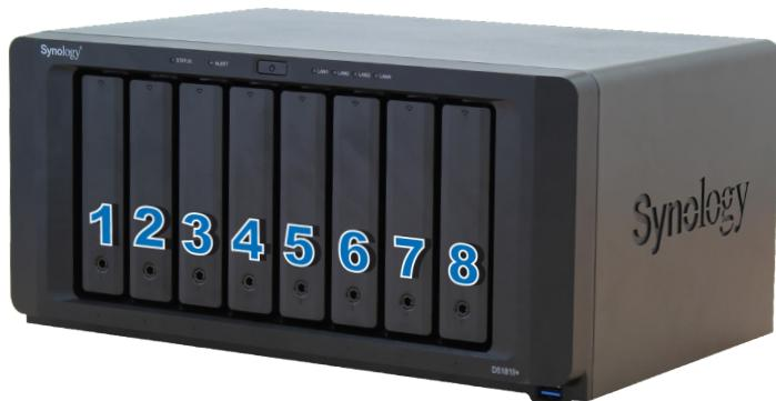
**Anmerkung:** Für die Einrichtung eines RAID-Volumes wird empfohlen, Laufwerke der gleichen Größe zu installieren, um die Kapazität der Laufwerke optimal auszunutzen.
