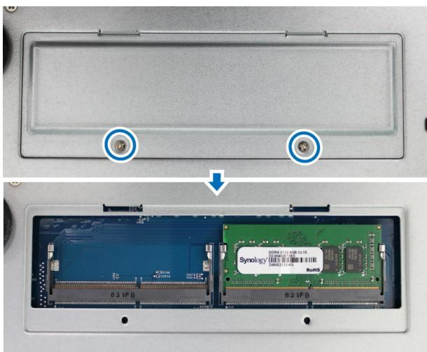
**Wichtig:** Durch Entfernen der Bodenplatte werden empfindliche interne Komponenten freigelegt. Berühren Sie beim Entfernen oder Hinzufügen von Speicher ausschließlich die Speicherbauteile.
