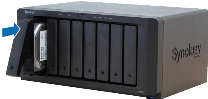
**Anmerkung:** Achten Sie darauf, dass der Einschub vollständig hineingeschoben ist. Ansonsten funktioniert das Laufwerk möglicherweise nicht korrekt.
