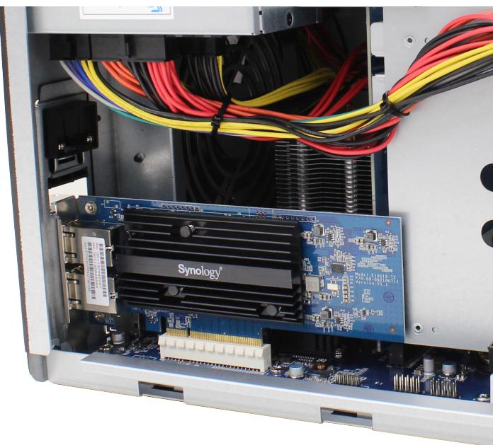
**b** 使用兩根手指，穩固且平均地向下按壓介面卡及介面卡的固定片。
