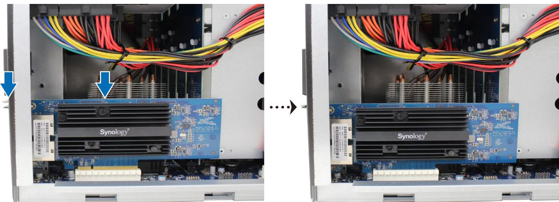
**c** 推回扣鎖來固定新安裝的網路介面卡。
